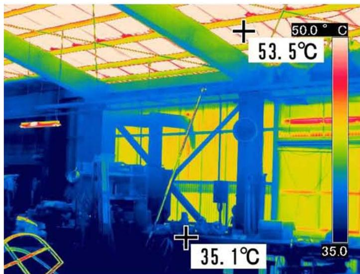
断熱未施工の工場では、外気温 29°Cに対して屋根裏温度が 55°C前後と 25度以上も高くなり、室内は輻射熱によって 35°Cにもなります。
